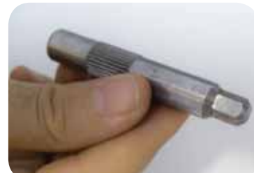
به سطوح تخت چندوجهی (انتهای قطعه) و قسمت آجدار روی قطعه توجه کنید.
